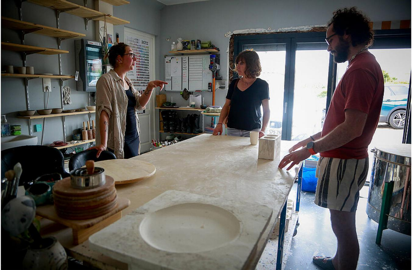
Dans un premier temps, c'est dans leur garage qu'ils ont installé leur atelier. Marion y façonne les modèles qu'elle a imaginés, Quentin réalise des moules en plâtre pour leur production. Un mélange d'argile et d'eau, la barbotine, est coulée dans les moules. Après la cuisson, vient l'émaillage, réalisé au pinceau, par pulvérisation ou bien par trempage. Au final : une vaisselle design et fine, qui marie étonnamment la résistance et la légèreté.
